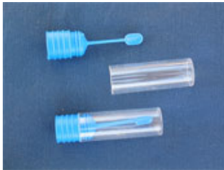
Abb. 1: Röhrgläser mit Plastikspatel und Steckverschluss
